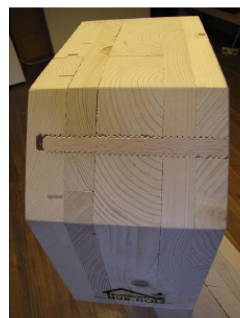
Een stukje doorgezaagd paneel laat zien hoe de houten schroef de diverse lagen verbindt.
